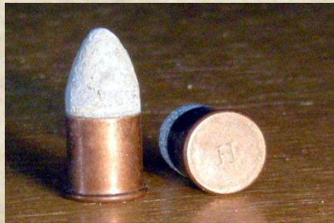
*Kaliber .41 Randfeuerpatrone - deutlich erkennbar: die kurze Hülse mit entsprechend kleiner Treibladung*
